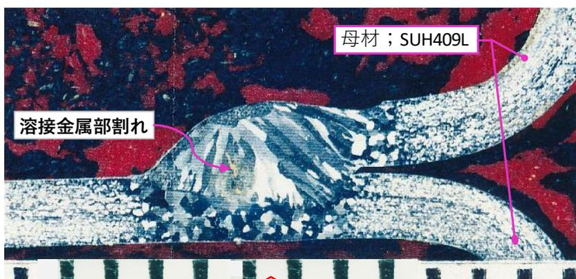
写真200-03 粒界割れを生じた横断面クロ組織の一例
