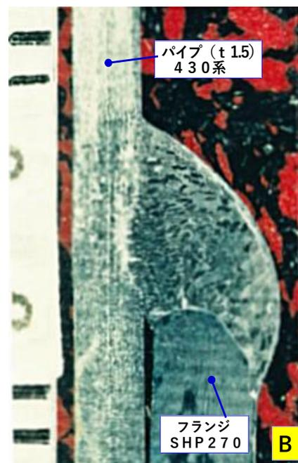
写真193-2-1 パイプ + フランジ 溶接部のマクロ組織
