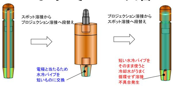
1台のスポット溶接機で、スポット溶接とプロジェクションナット溶接を段替えしながら ご使用されている場合、
