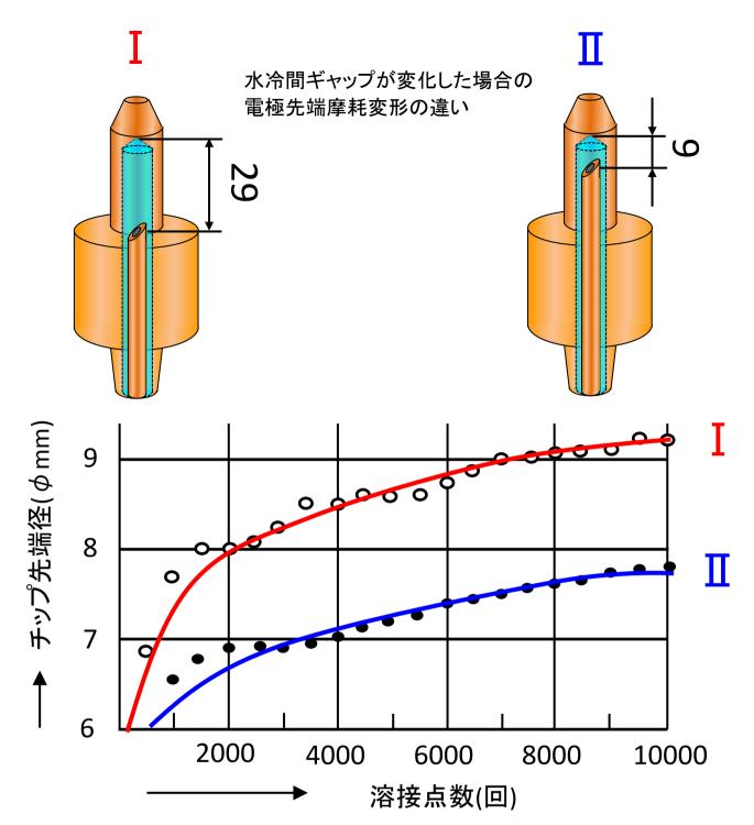
クロム・ジルコニウム銅使用、軟鋼板厚0.9mm 電流7,500A、時間8サイクル、加圧力210kgf、溶接速度80点/分
