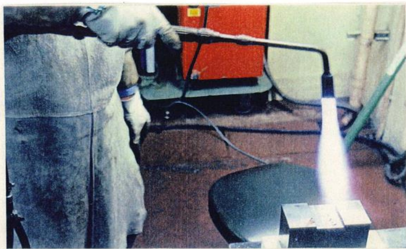
酸素－アセチレン炎による加熱状況例
