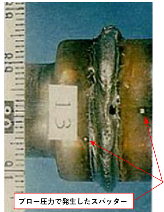
写真142-01a 円周溶接ラップ部に発生したブローとその外観
