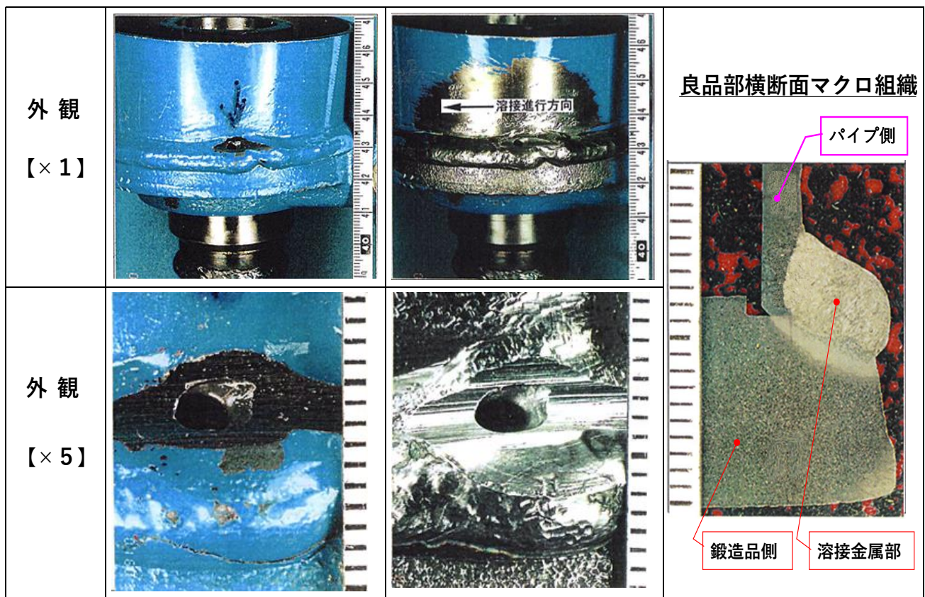
写真141-01 円周溶接品のラップ部に生じたブローホール発生品の外観
