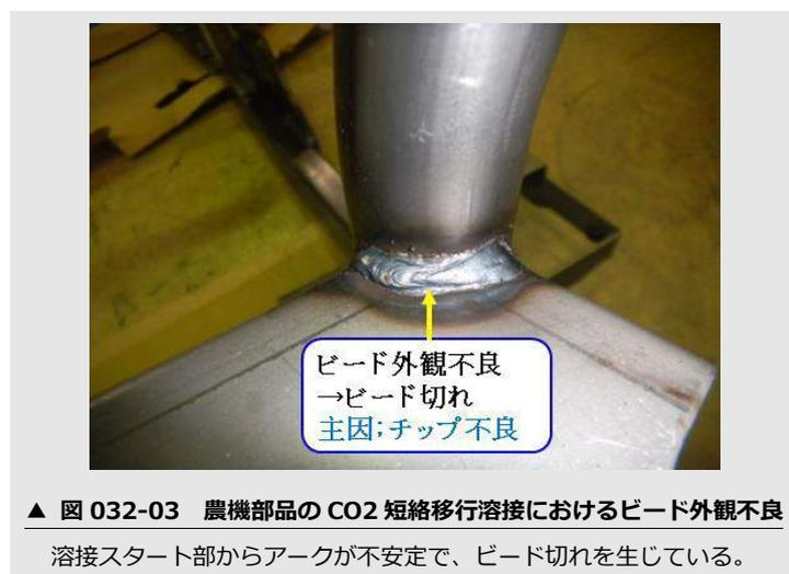
**ビードは給電不良と送給不良が重なった状況**となり、ビードの波が不規則で、部分的に大きな**ビード切れ**を呈している。またビードの両端にスパッター付着を伴うビラビラの状態になっている。これらは溶融池を移行ワイヤ、移行溶滴が激しく叩いたことを示すもので、それらの原因はチップ不良と推定できます。
