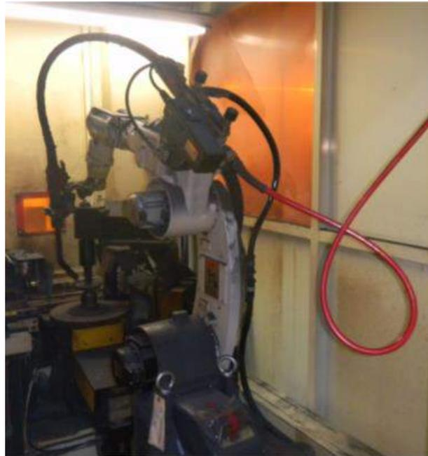
▲ 図 023-04 4ロール送給装置と1次側コンジットの取付
