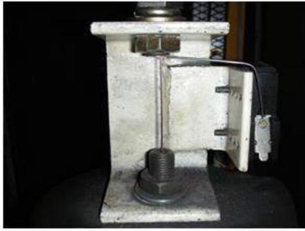
▲ 図026-03 リミットスイッチ+レバー式ワイヤ検出器
