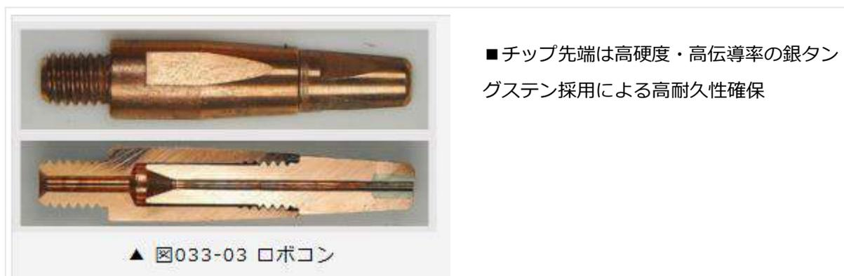
先端材質は高硬度・高導電率の銀タングステンを採用することにより高耐久性を確保しています。ワイヤ径はφ 0.8～1.2 に対応でき、アダプター使用時のチップ全長は 40mm、45mm を選択できます。ロボット溶接工程で負荷が高く、チップ交換頻度の高い工程への導入をお勧めします。さらにチップへの強い要求特性はスパッター付着がしにくい、付着しても払えば容易に落とすことができるチップです。これらの要望に沿ったチップの一つとしてマグビー処理チップ (図 033-04) があります。
