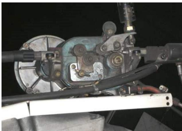
図 028-01 ロボットアーム上のワイヤ送給装置
