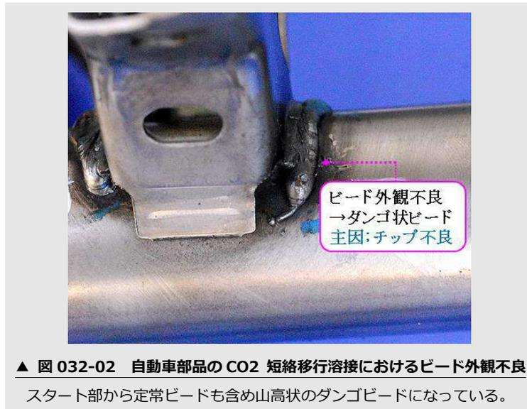
いずれも**不良の主因はチップ**にあり、**給電不良**と考えられる。給電が不良になるとワイヤは溶着するもののアーク停止時間が生ずるので適正なビード形状が得られなくなる。図 032-03 には農機部品の CO2 短絡移行溶接におけるビード外観不良発生の例で溶接スタート部からアークが不安定で「**ビード切れ**」を生じている。
