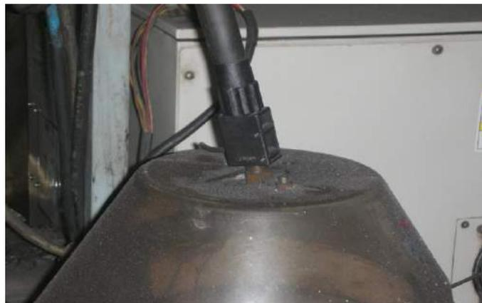
▲ 図 027-01 透明傘破損による 1 次側コンジットの倒れ（透明傘破損、引き出し金具締め付け不良などによるコンジット倒れはワイヤキズ、ワイヤ曲りに直結）
