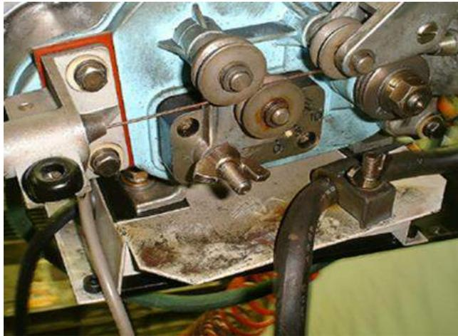
図 028-03 4WD送給装置周りの銅粉、鉄粉
