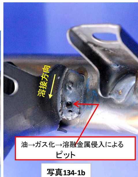
写真134-01 ビード表面に開口したピットとフクレの事例
