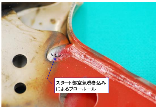
写真133-01 普通鋼板CO 2 ・T字すみ肉溶接のスタート部に発生したピットとその外観
