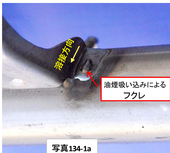
写真134-01 ビード表面に開口したピットとフクレの事例
