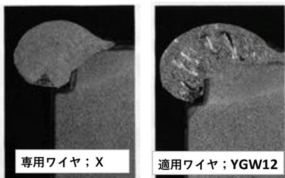
図131-03 浸炭・窒化処理部品へのCO2溶接適用例
