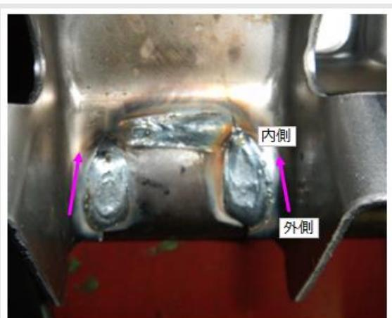
\* この溶接品は矢印の方向にトーチ走行しているがシールドガスが閉構造部に溜まりやすく圧力を生じアークを乱しやすい。できれば、溶接方向は反対に外側に向かって進めることが望ましい。
